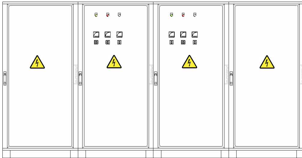
Рис. 1.1 Внешний вид ГРЩ со стороны фасада
